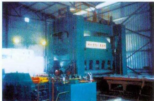
宝鸡桥梁厂七辊矫平机减速器
