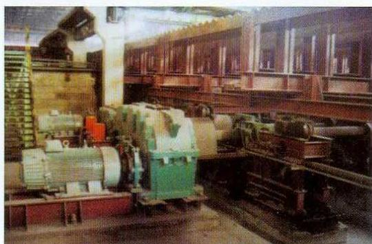
邢台钢厂 DNK1570 中硬齿面减速器
