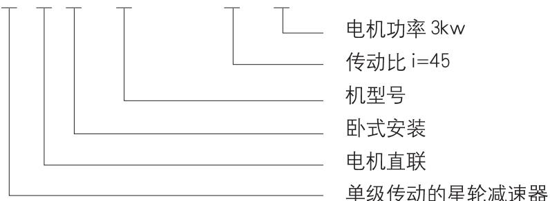
示例 1：机型号为 26B，传动比为 45，卧式不带电机，输出轴采用花键孔输出，则标记为：HJW26B-K-45。
