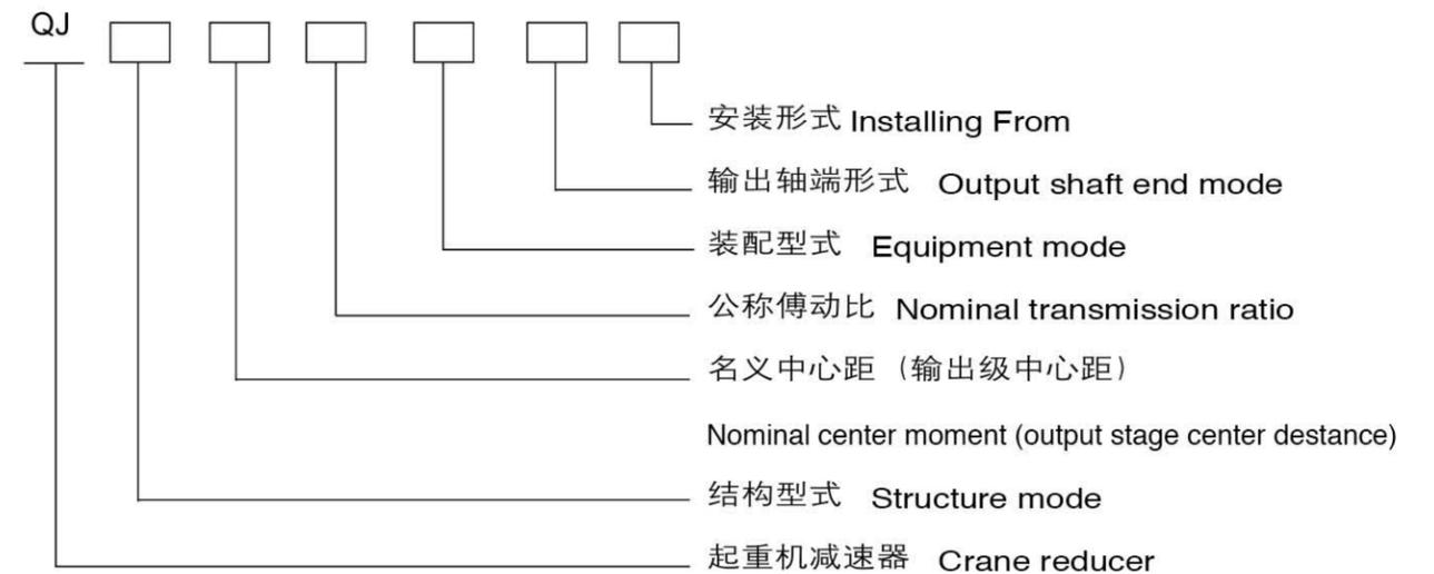
标记示例: 起重机减速器三级传动, 名义中心距  $a_1=560\text{mm}$ , 公称传动比 50, 装配型式第 III 种, 输出轴为齿轮轴端, 卧式安装则标记为: 减速器 QJS560-50-III -cw
