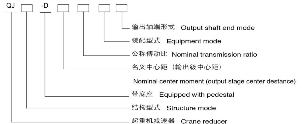
标记示例: 起重机减速器二级传动, 名义中心距  $a_1=560\text{mm}$ , 公称传动比 20, 装配型式第 VI 种, 轴端形式为 p 型, 则标记为: 减速器 QJR-D560-20-VIP
