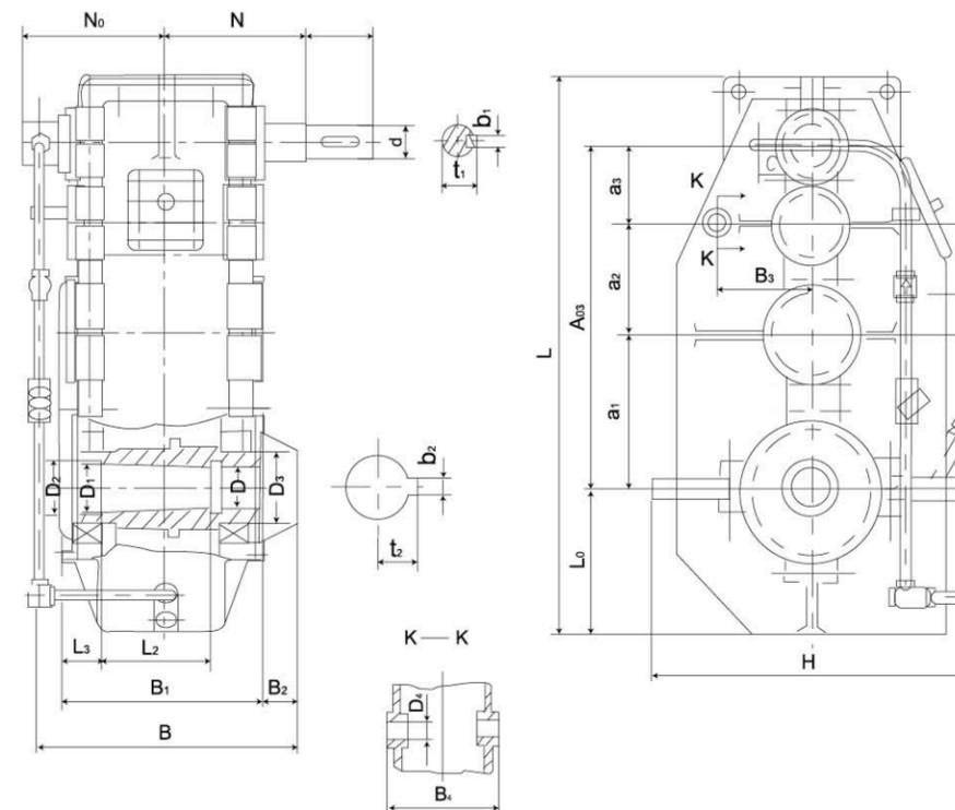
图 2-15 QJG-T 型减速器外形及安装尺寸
