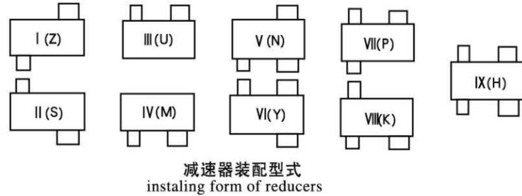
QJR、QJS、QJRS 型安装形式: 卧式W或立式L(V)在偏转角  $\pm a^\circ$  范围内, 为立式安装。
