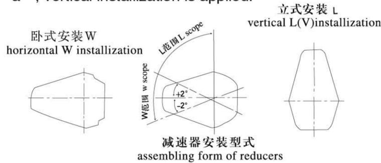
注:  $a$  角的度数与传动比有关, 当减速器倾  $a$  度时, 应保证使中间级大齿轮沾油 1-2 个齿高深度。
