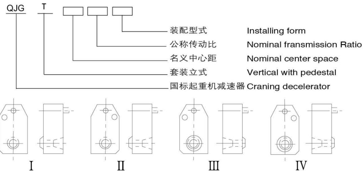
图 2-14 QJG-T 型减速器装配型式
