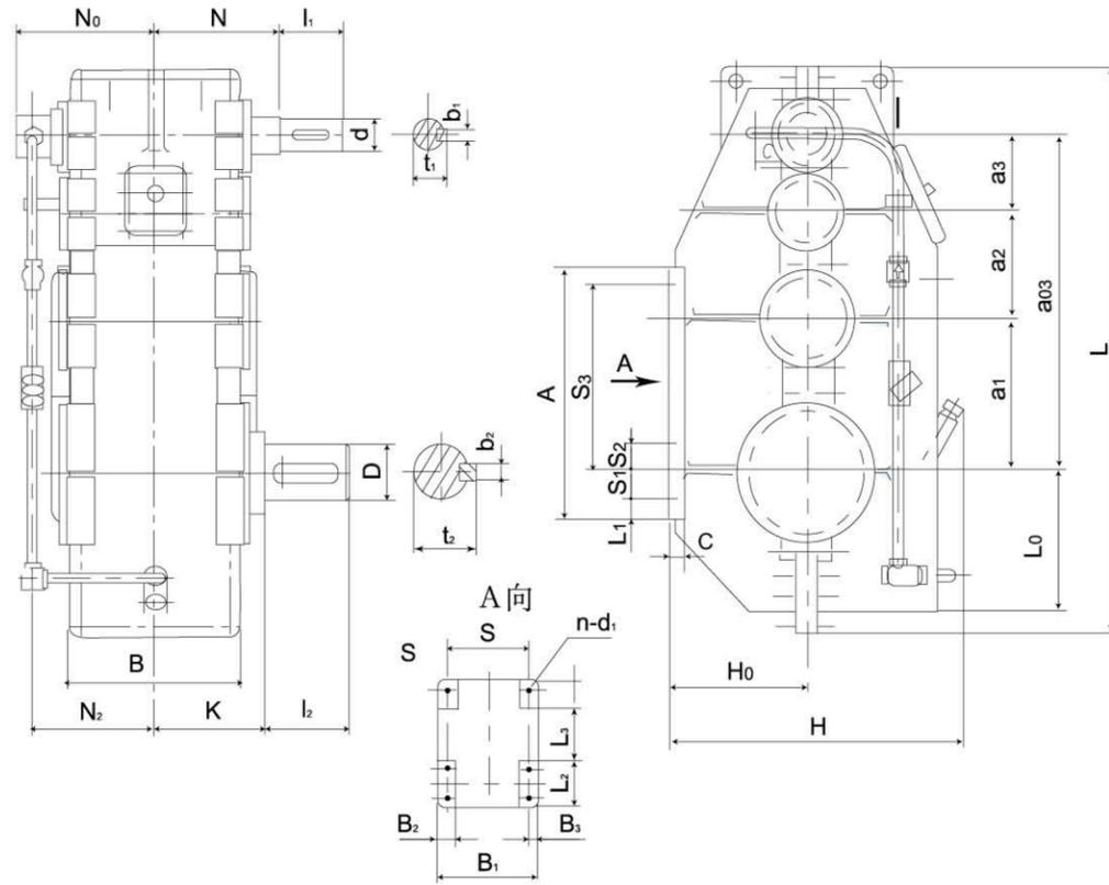
QJG-L 型减速器的外形及安装尺寸
